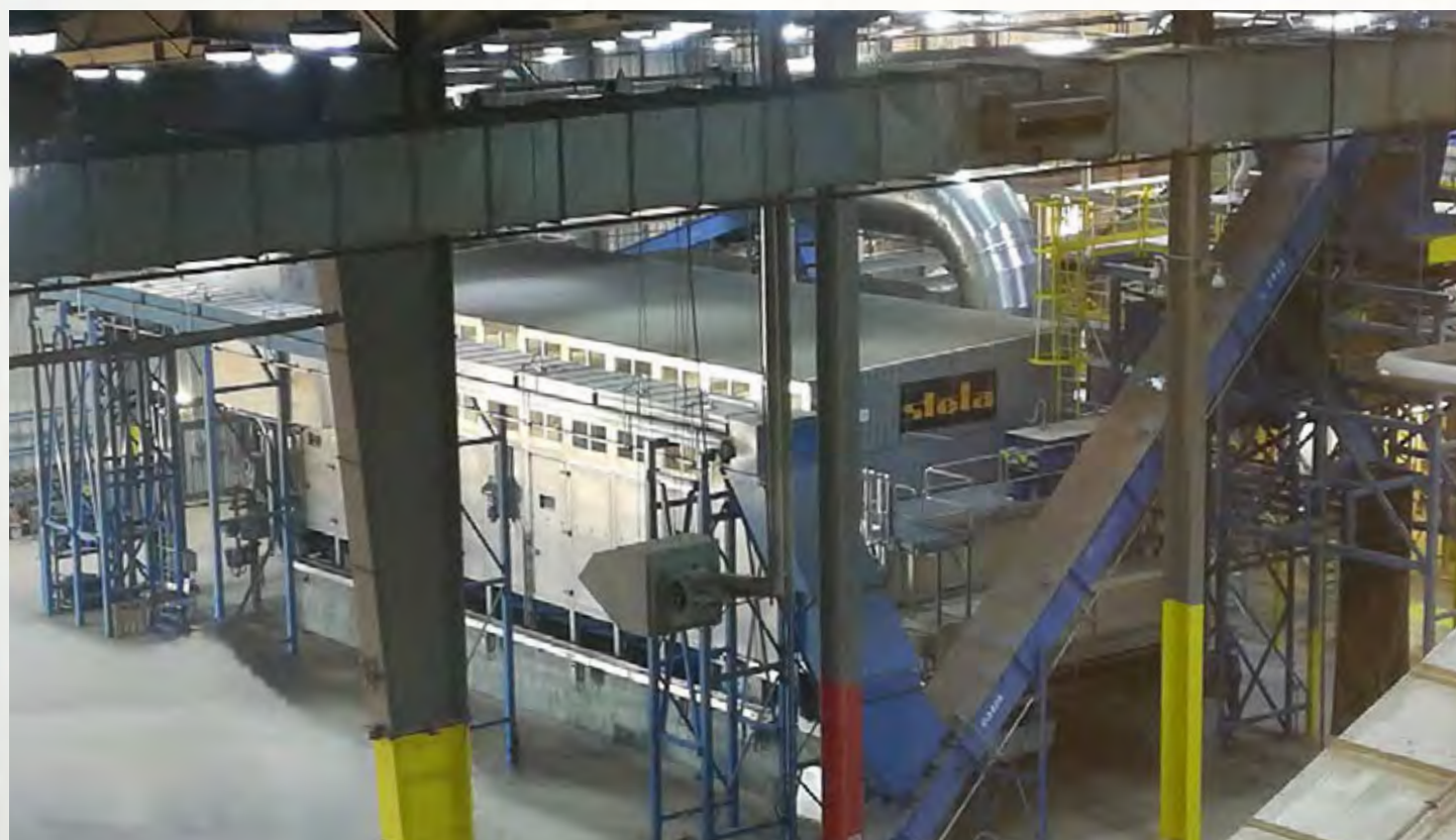
项目地：Edmonton Cement, 加拿大 | 型号：BTU 1/6200-18 | 安装年份：2018 干燥物料：RDF垃圾燃料 | 出料能力：约3.0吨/小时 | 降水区间：50% - 10%湿度
