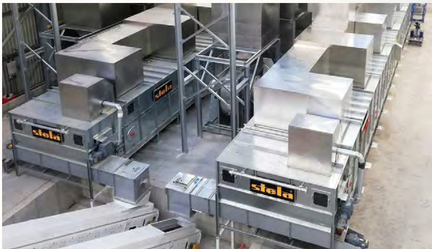
项目地：AV Dawson, 英国 | 型号：2x BTL 1/3000-22 | 安装年份：2021 干燥物料：SRF固体回收燃料 | 出料能力：约36.0吨/小时 | 降水区间：20% - 10%湿度
