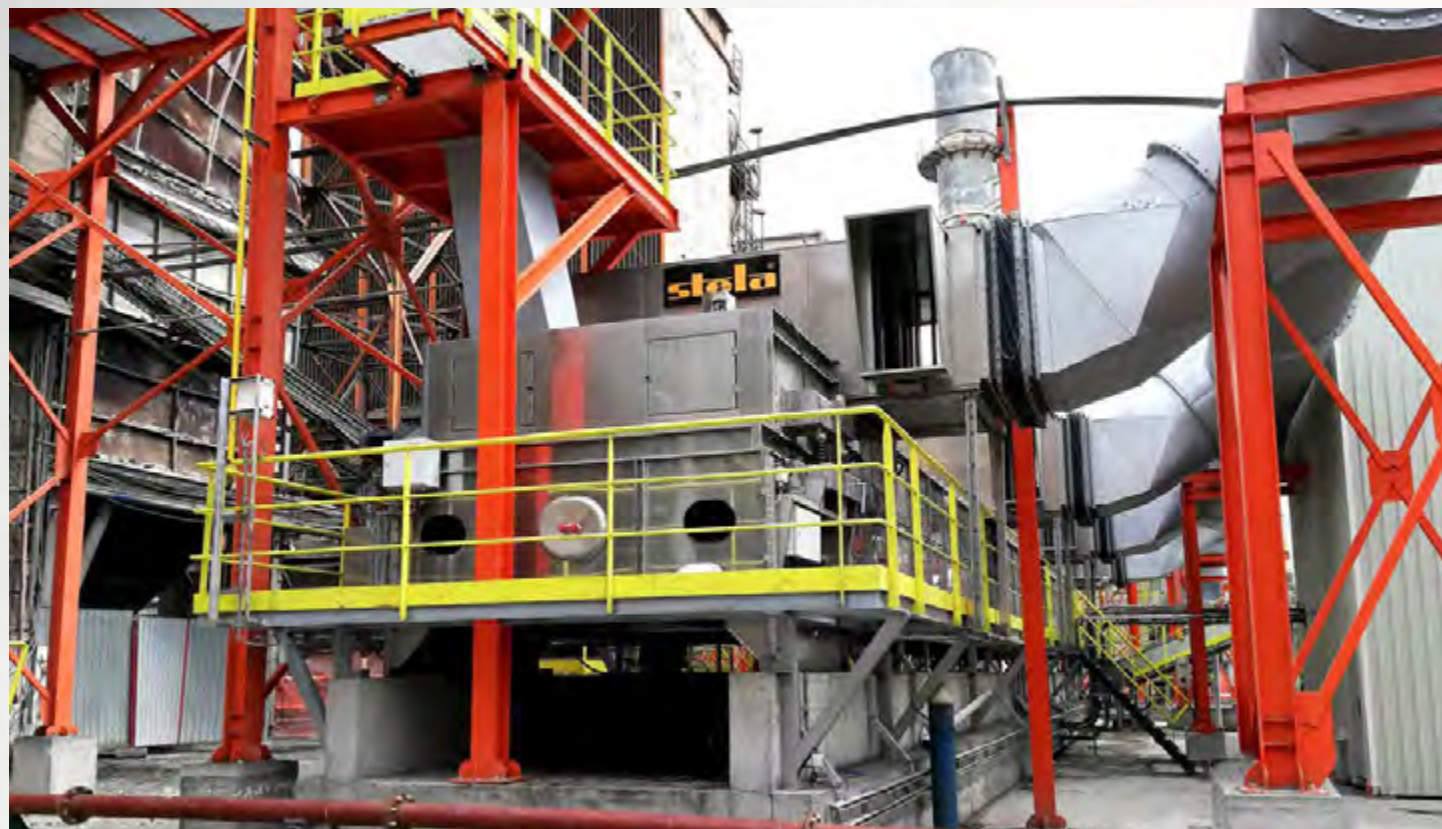
项目地：CRH Romania, 罗马尼亚 | 型号：BTL 1/3000-25 | 安装年份：2019 干燥物料：SSW固废垃圾 | 蒸发量：最大3.3吨/小时
