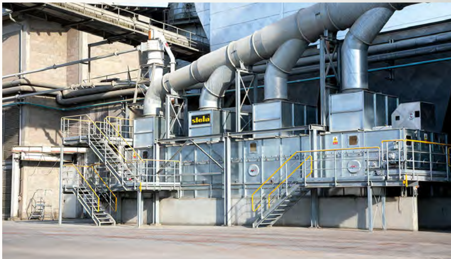
项目地：南德水泥, 德国 | 型号：BTL 1/3000-14 | 安装年份：2017 干燥物料：RDF垃圾燃料 | 蒸发量：最大1.1吨/小时
