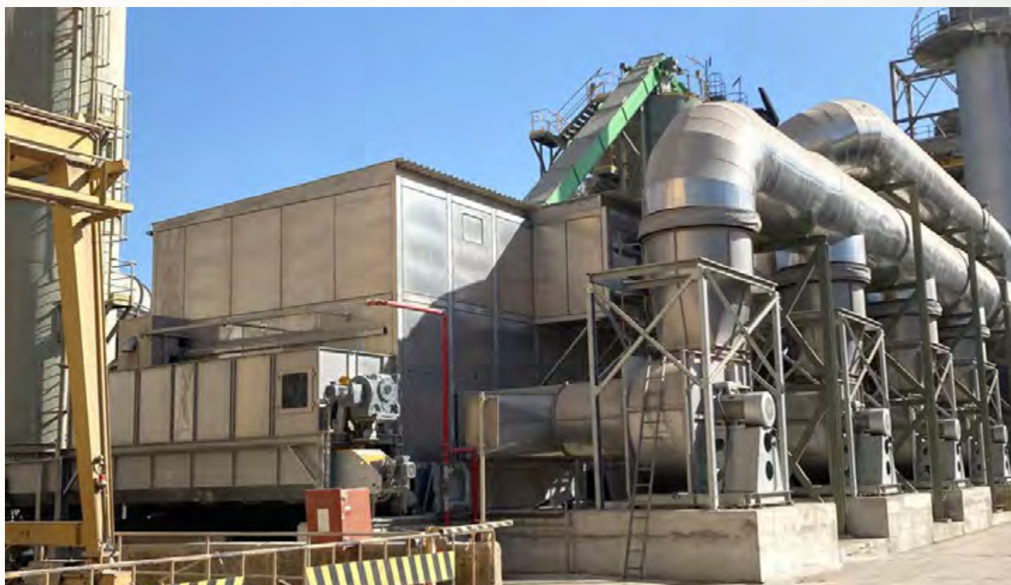
项目地：Secil水泥, 葡萄牙 | 型号：BT 1/6200-30 | 安装年份：2022 干燥物料：RDF垃圾燃料和MSW城市固废 | 出料能力：约20.0吨/小时 | 降水区间：35% - 15%湿度
