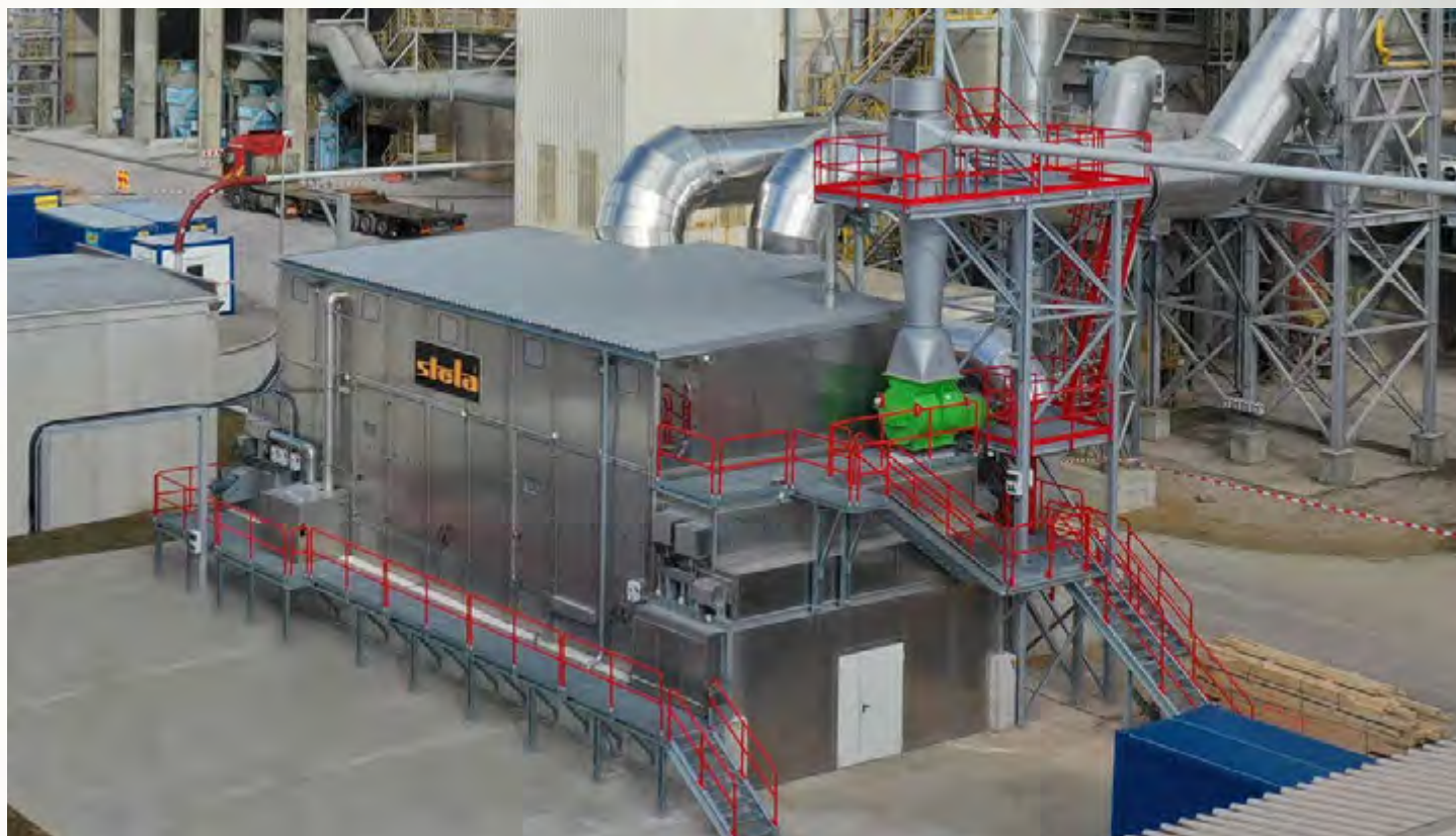
项目地：Schwenk, 拉脱维亚 | 型号：BT 1/6200-13.5 | 安装年份：2021 干燥物料：RDF垃圾燃料 | 出料能力：约7.7吨/小时 | 降水区间：25% - 3%湿度
