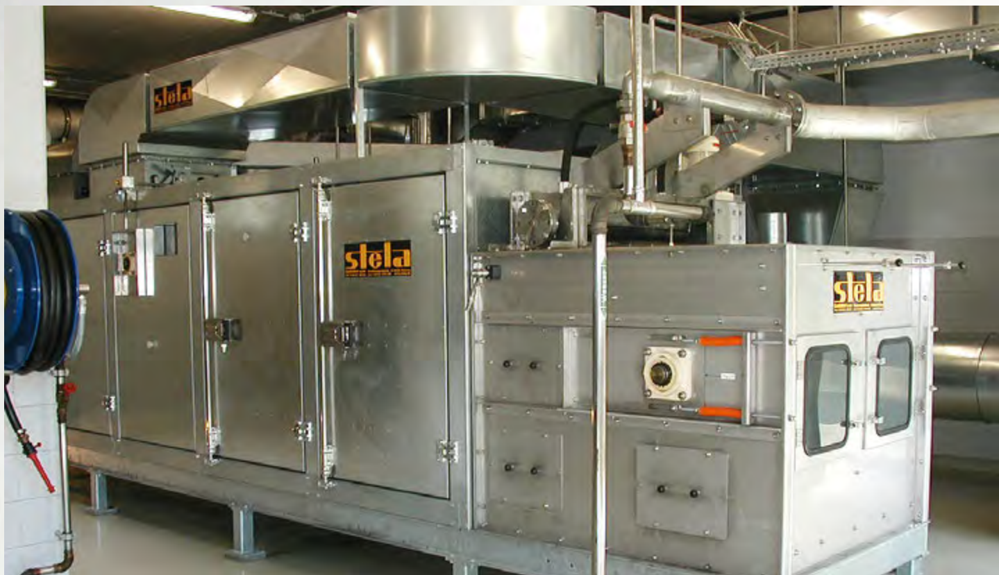
项目地：Abwasserverband Unteres Wipptal, 奥地利 | 型号：PBTk 1/1000-5 | 安装年份：2002 干燥物料：市政污泥 | 蒸发量：100公斤/小时
