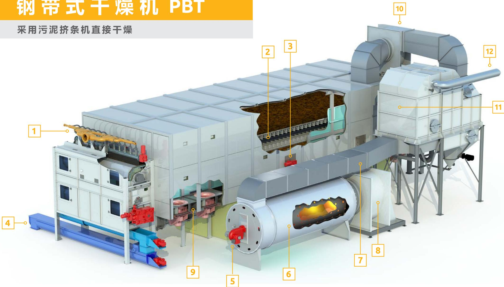
1 = 挤条机 | 2 = 不锈钢网带 (特氟龙涂层) | 3 = 翻料器 | 4 = 水冷出料螺旋 | 5 = 新风 | 6 = 热风炉 | 7 = 热回收
