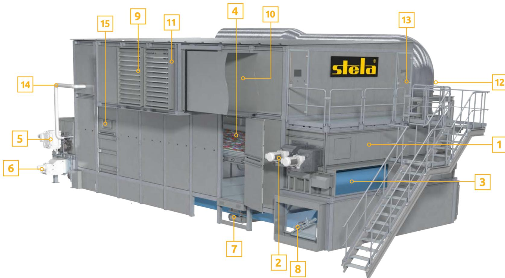
1 = 喂料端 | 2 = 双喂料螺旋 | 3 = 干燥网带 | 4 = 物料层 | 5 = 网带驱动 | 6 = 出料螺旋 | 7 = 网带水洗清洁系统 | 8 = 网带纠偏控制系统
