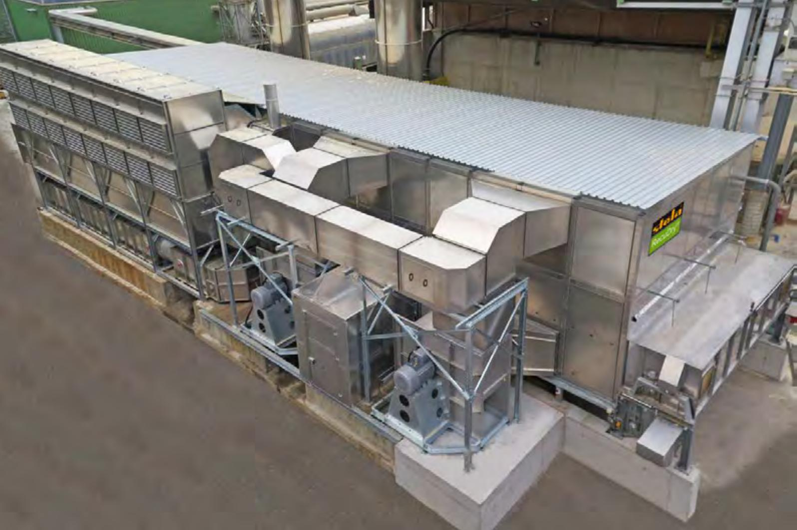
低温带式干燥技术进一步发展，拥有专利的“RecuDry”施德兰低温带式干燥技术可节能高达35-55%的能源。
