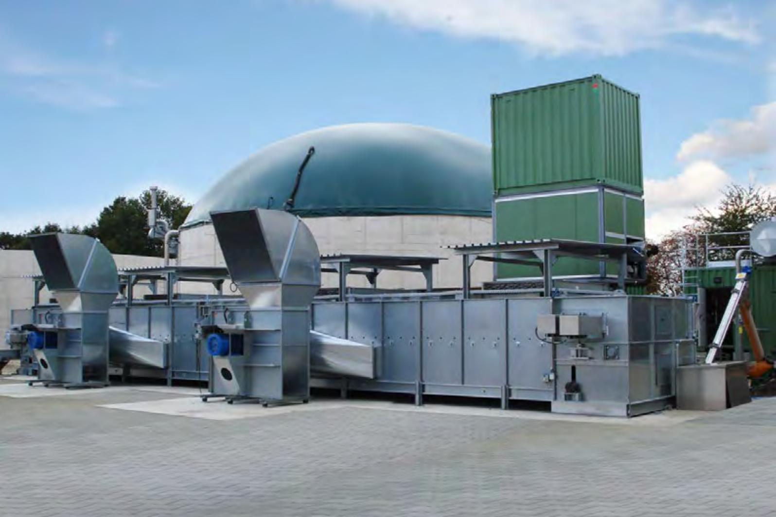
研发利用沼气废热干燥发酵沼渣的带式干燥机。
