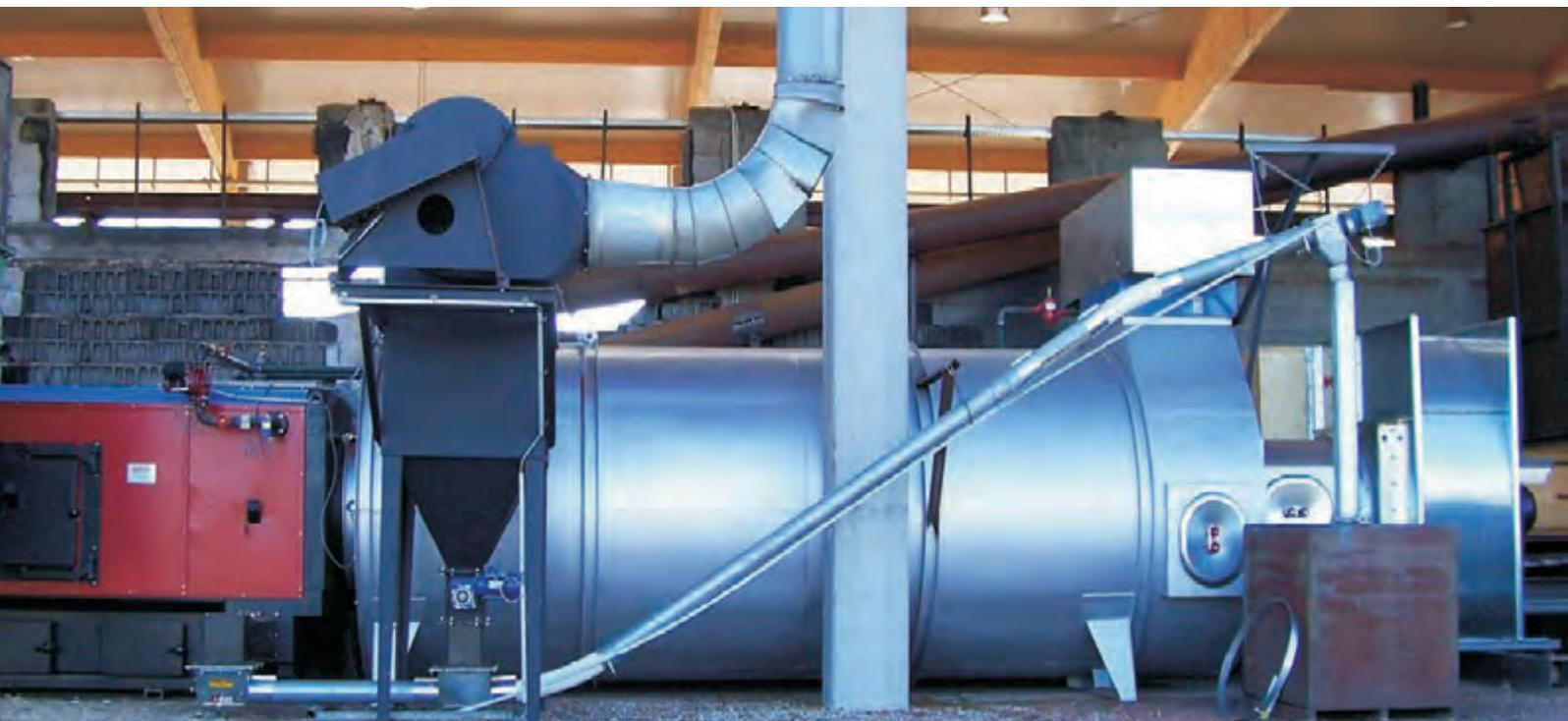
交付第一台生物质木屑供热干燥玉米设备
